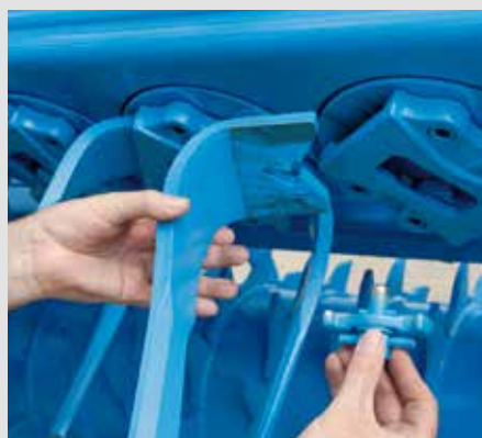
Быстрая замена ножей безболтового крепления
