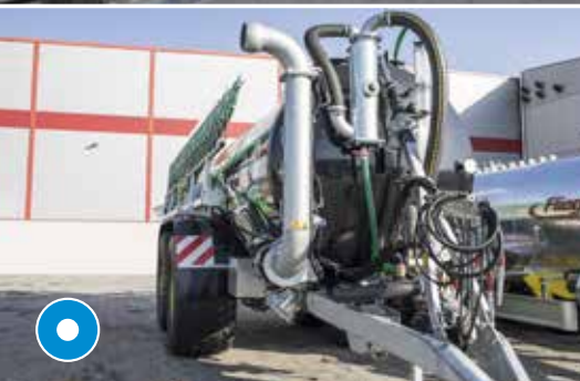
Всасывающий рукав слева или справа для удобства использования
