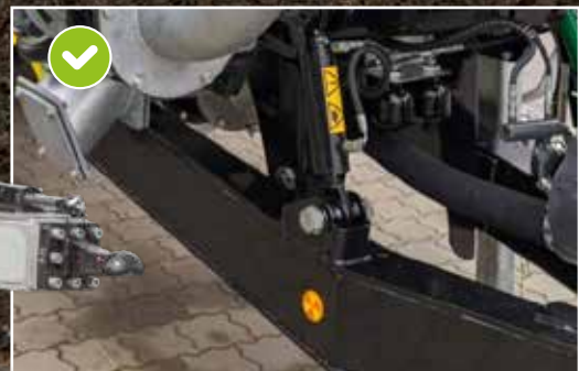
Амортизация дышла с обеих сторон
