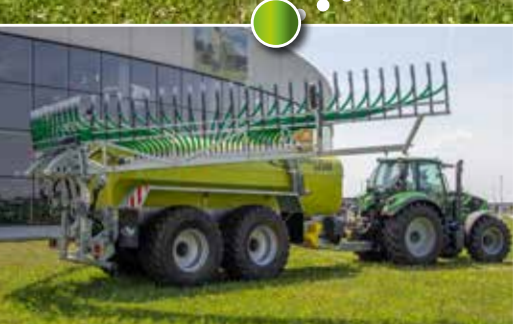
Специальный механизм складывания не допускает перегиба выпускных шлангов
