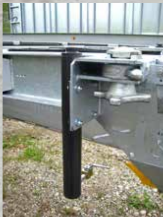
Цилиндр для гидравлического подъемного механизма
