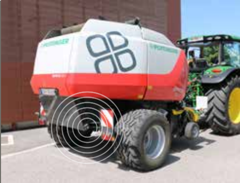
Пример крепления радиомаяка на прессе для круглых тюков
