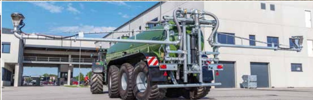
Штанговый распределитель с максимальной рабочей шириной 21—30 м
