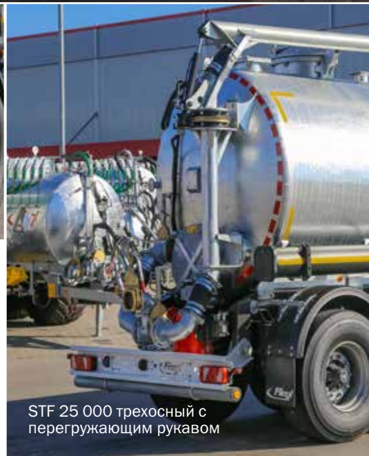
в помповом исполнении с ротационным насосом Vogelsang
