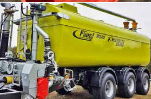
Roadx Poly Line с ротационным насосом с механическим приводом для всасывания
