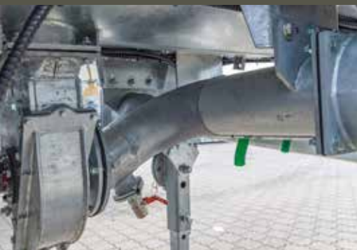
Турбозаполнитель по центру под цистерной
