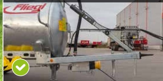
Опрокидывающий цилиндр цистерны с опорой для объема от 5000 л
