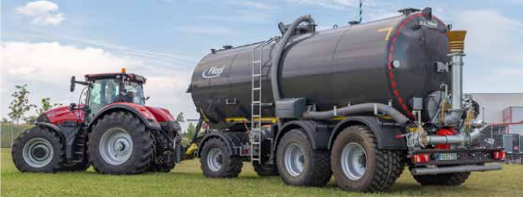
Полуприцепная цистерна STF 27 500 со встроенной тележкой Dolly
