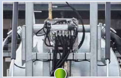
Блок управления с масляным фильтром
