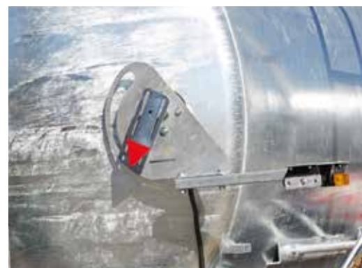
Указатель уровня заполнения с шаровым поплавком
