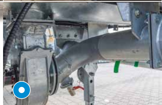
Гидравлический турбозаполнитель, по центру под цистерной
