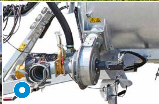
Боковой турбозаполнитель слева или справа
