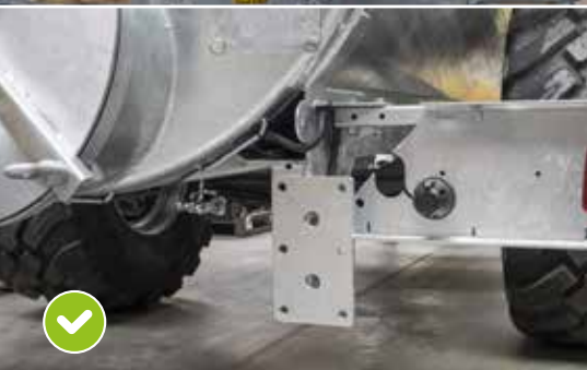
Навесная консоль для шлангового или башмачного распределителя в СЕРИЙНОЙ КОМПЛЕКТАЦИИ для объема от 5000 л
