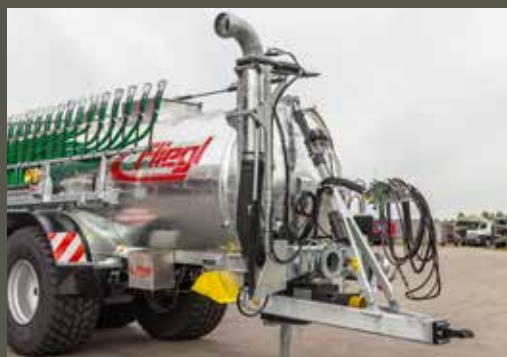
Всасывающий рукав помповой цистерны 8"
