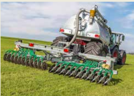
Наклонное положение дисков раскрывает почву для прямого внесения навозной жижи
