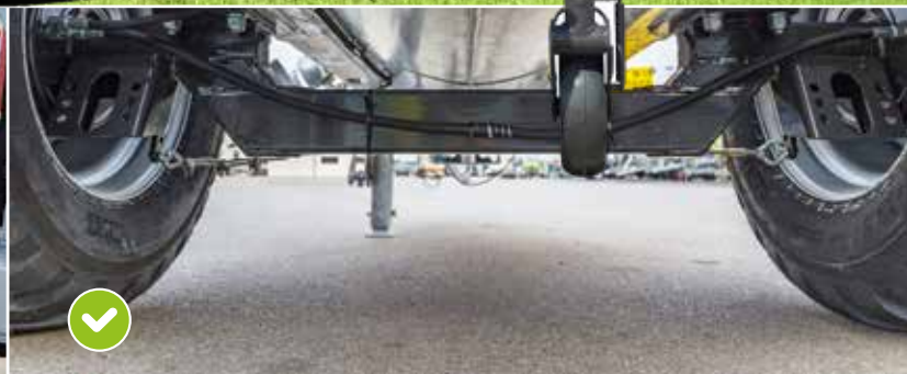
Цистерны объемом от 5000 литров с изогнутой балкой: низкий центр тяжести обеспечивает отличные ходовые качества при работе на склонах
