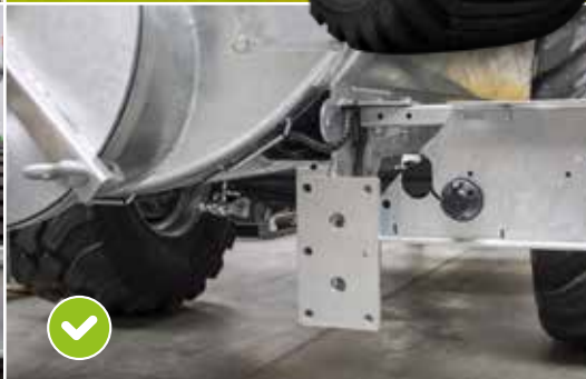
Навесная консоль для шлангового или башмачного распределителя в СЕРИЙНОЙ КОМПЛЕКТАЦИИ для объема от 5000 литров
