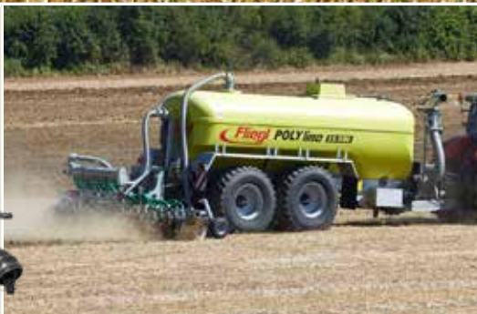
PFW 15 500 с дисковым культиватором для навозной жижи «Maulwurf», 6 м
