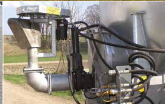
Гидравлический маятниковый распределитель с рабочей шириной 12—18 м.
