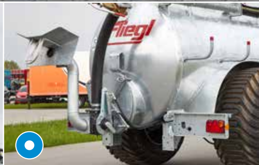
Промывочный трубопровод (функция перемешивания)
