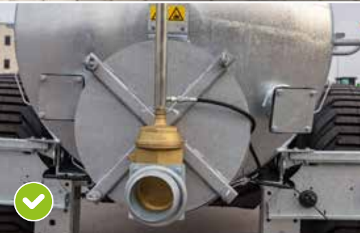
Глухой фланец сзади и подготовка к опорожнению на склонах
