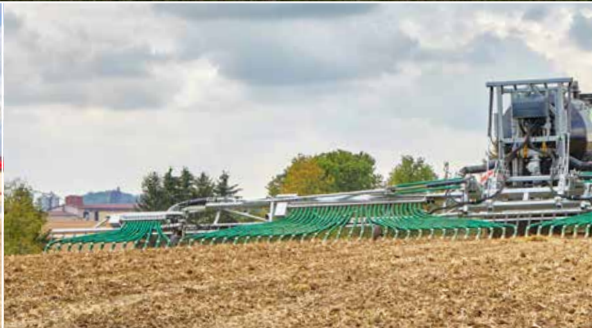
Fliegl SKATE 210 с качающейся рамой для улучшения выравнивания на склоне (только SKATE 210/240)
