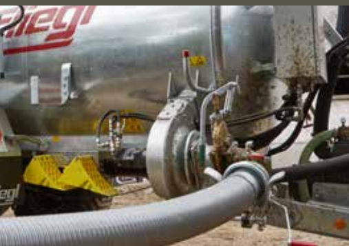
Турбозаполнитель с быстросъемной муфтой (6 или 8")
