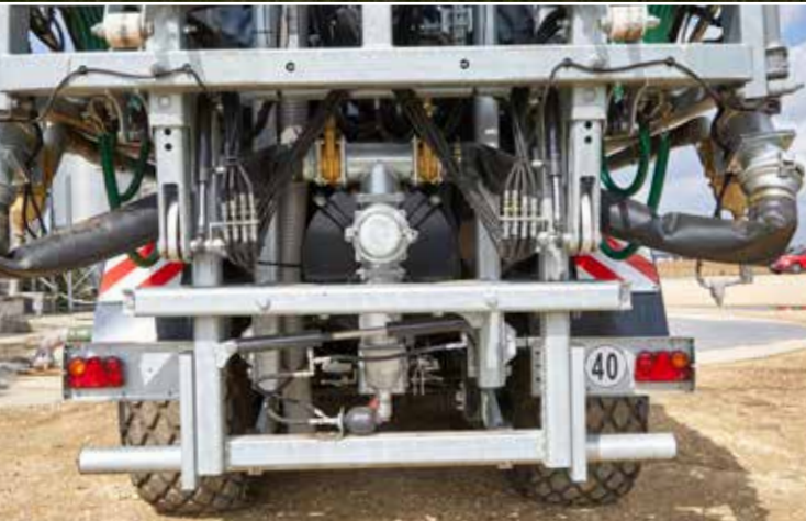
Fliegl SKATE 210 с качающейся рамой для улучшения выравнивания на склоне (только SKATE 210/240)
