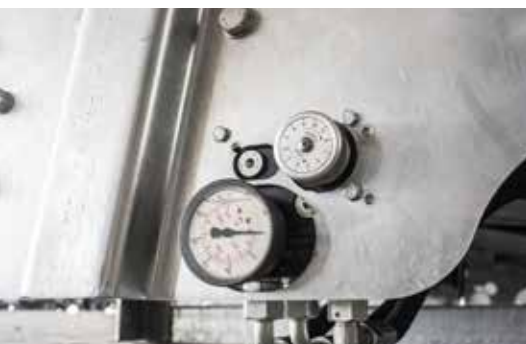
Механический потенциометр с регулировкой скорости подачи разбрасывателя
