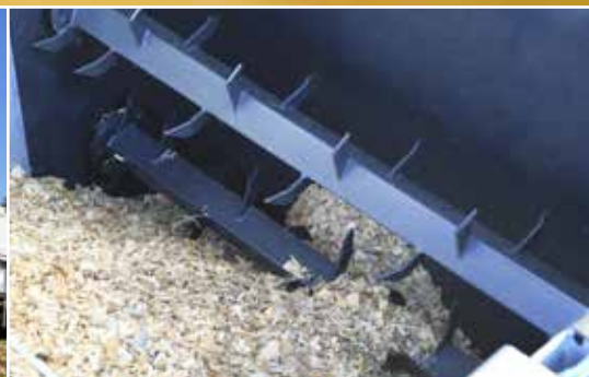
Распределительные вальцы обеспечивают равномерную подачу
