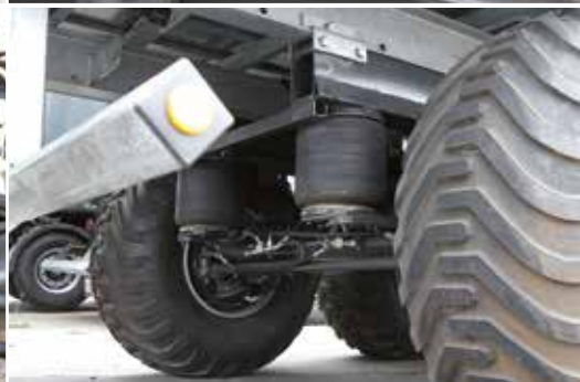
Опция: пневматические рессоры с автоматическим опусканием
