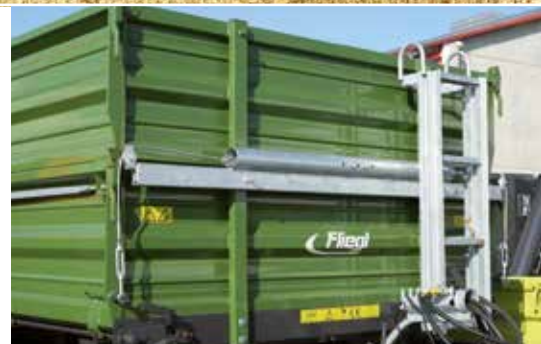
Опция: натяжная пружина бортовой стенки в усиленном исполнении
