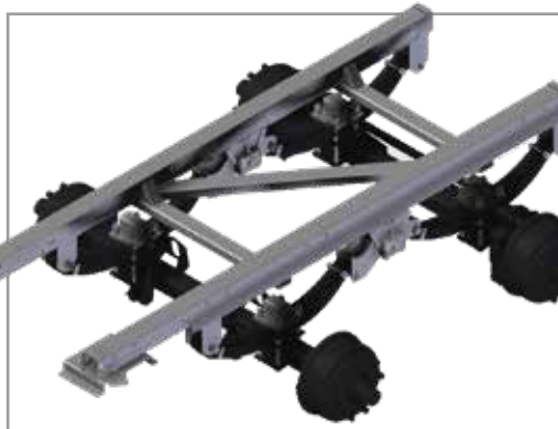
Осевой агрегат Tandem Gigant - параболические рессоры
