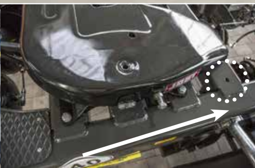
Механическая регулировка панели седельно-сцепного устройства для для Dolly одноосной и Tandem
