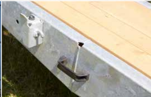
Выдвигаемая рампа с деревянным покрытием, площадкой из стали 3,5 мм - модель ТРА 120
