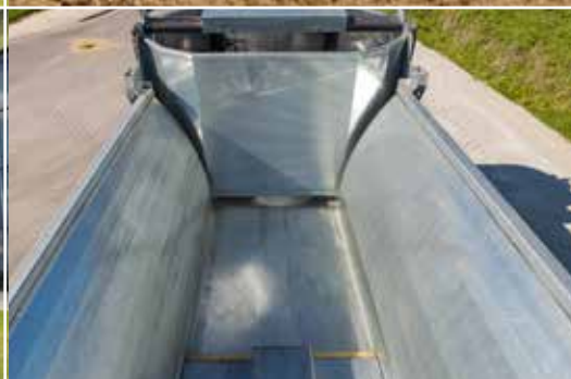
Незначительный износ гидравлической выдвигающей системы
