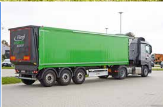
ASS GREEN-TEC Сельскохозяйственный полуприцеп из алюминия с седельно-сцепным устройством
