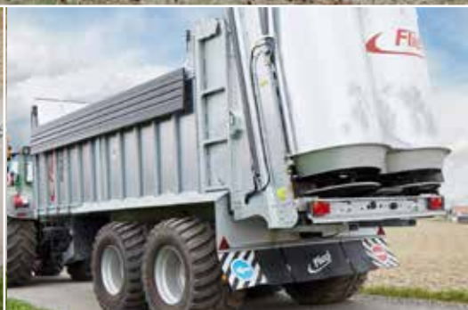
Механическое откидывание боковых стенок.
