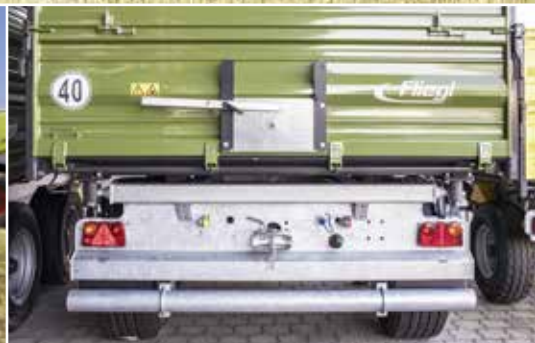
Версия 40 км/ч с защитным брусом и грязезащитным крылом
