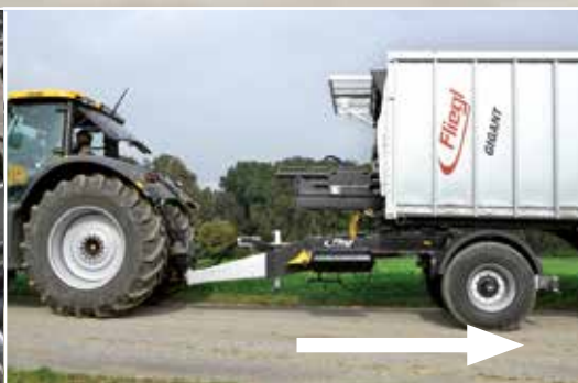
Гидравлическая регулировка панели седельно-сцепного устройства для Dolly одноосной и Tandem
