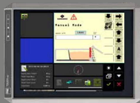
ISOBUS Multi - Control – система мульти-управления транспортным средством. Позволяет параллельное использование FLIEGL VARIO SENS с FLIEGL TRAILER CONTROL. Multi - Control упрощает работу пользователя и повышает эффективность использования техники.
