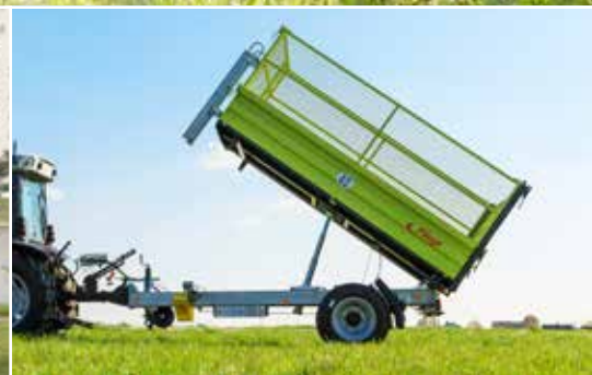
EDK 25 с бортовой решетчатой надставкой для транспортировки листьев
