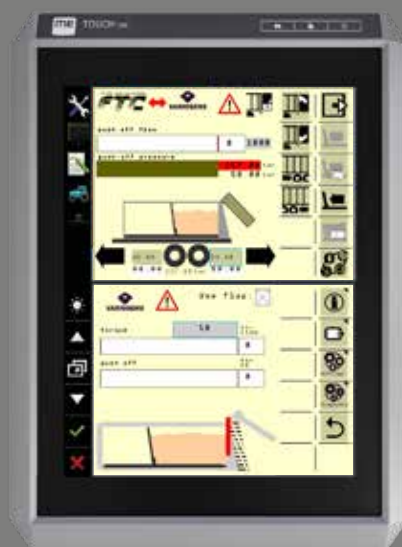
ISOBUS Multi - Control – система мульти-управления транспортным средством. Позволяет параллельное использование FLIEGL VARIO SENS с FLIEGL TRAILER CONTROL. Multi - Control упрощает работу пользователя и повышает эффективность использования техники.
