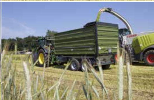
Гидравлическая задняя стенка с интегрированными бортами
