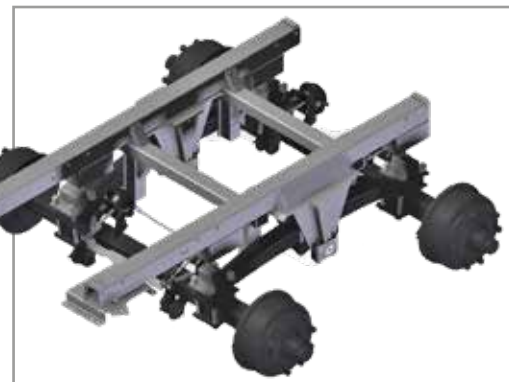
Осевой агрегат Titan-Tandem для лучшей балансировки на поверхности
