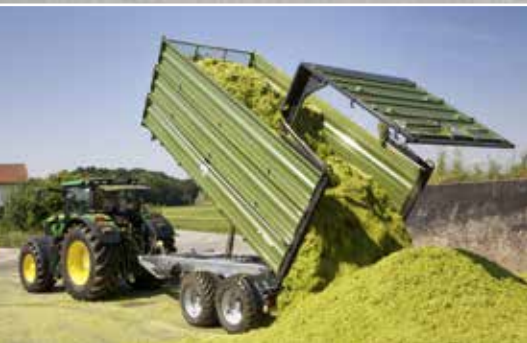
Самосвальный полуприцеп для силоса с задним гидравлическим бортом
