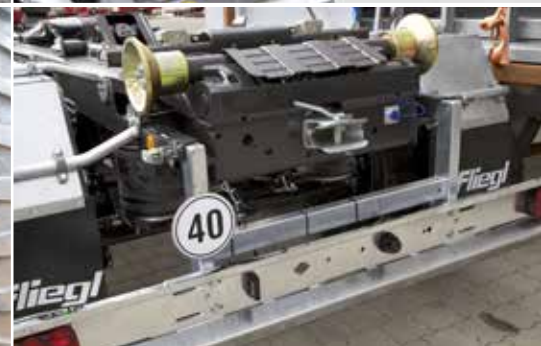
Опция: выдвжной защитный брус для контейнеров большой длины. Муфта для подключения тормозной системы и гидросистема для 2-го прицепа
