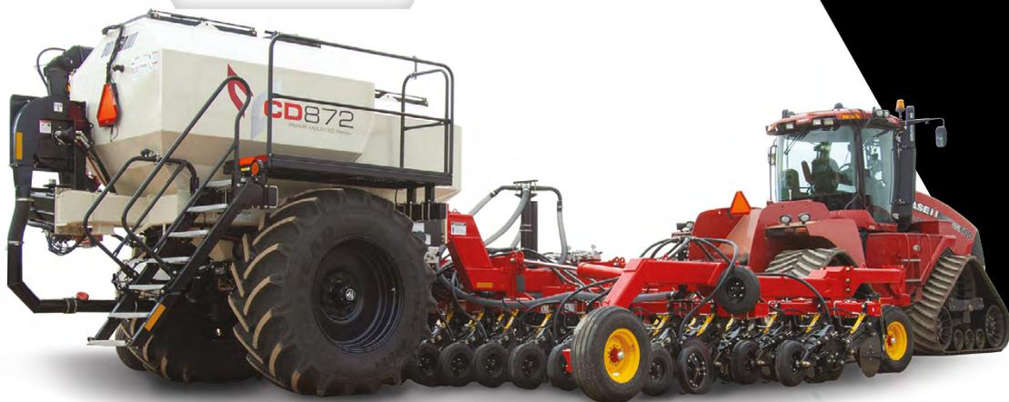
Посевные комплексы серии FMS с дисковыми сошниками обеспечивают равномерное и точное размещение семян при сохранении целостности посевного ложа. Это достигается благодаря комбинации тонкого, но в то же время сверхпрочного диска и уникального низкопрофильного скребка LDx™, который гарантирует прямую и точную траекторию подачи семян и удобрений максимально низко к режущему краю диска.
