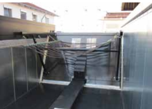
Гамак для картофеля уменьшает повреждения при загрузки картофеля в прицеп
