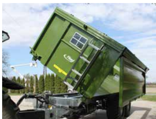
Самосвальный тракторный прицеп ТАНДЕМ с трехсторонней системой разгрузки очень прочен благодаря усиленным бортам
