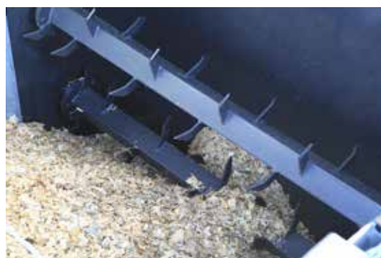
Распределительные вальцы обеспечивают равномерную подачу
