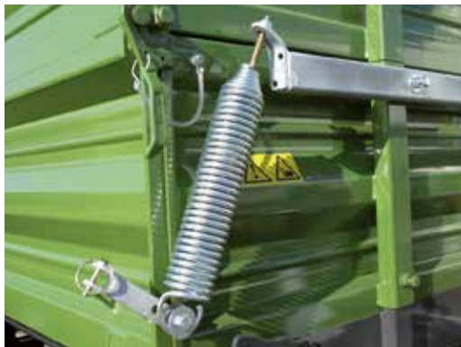
Пружинные стяжки борта
