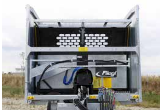
Массивная и надёжная выдвигающая система, точная проводка гибких шлангов, отсутствие деталей повышенного износа
