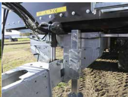
Гидравлически подрессоренное дышло
