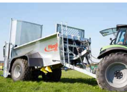
Гидравлически подрессоренное дышло - более комфортная езда
