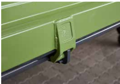
задвигной замок с центральной регулировкой (начиная от модели EDK 40 – серийно). Для рамы от 4.500 мм 6-ти кратный затвор, рама цельковая, без мест сварки
