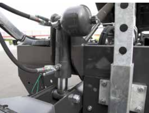
Гидравлически подрессоренное дышло
