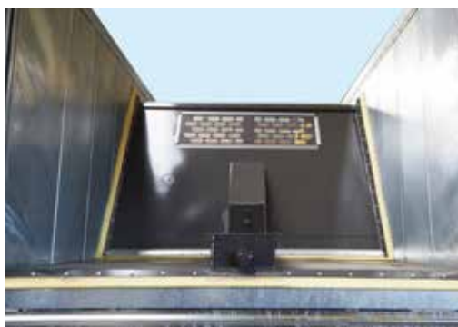
Уплотнители: абсолютно герметично для любого зерна. Полиэтановые уплотнители установлены под углом 45°
