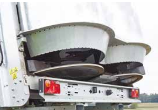
Разбрасыватель Profi V2 с маятниковыми лопаточками:
