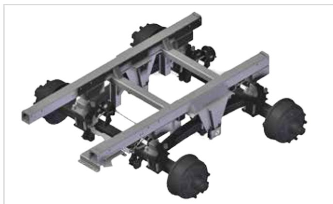
для лучшей балансировки Тандем-агрегат Titan на поверхности, не требует смазки и техобслуживания
