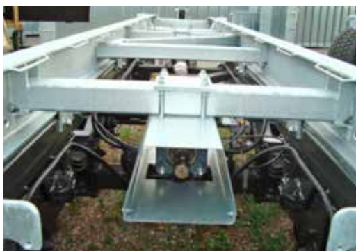
Сквозной привод вала отбора мощности механически приводит систему разбрасывания в действие / для навесного оборудования
