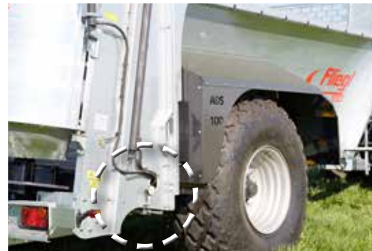
Регулировка подачи навоза на вальцы осуществляется механически в серийной комплектации или через электронный потенциометр опционально
