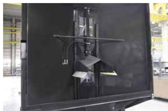
Гидравлическая затворная заслонка обеспечивает полную разгрузку перегружающего шнека
