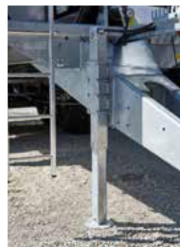
Гидравлическая передняя опора
