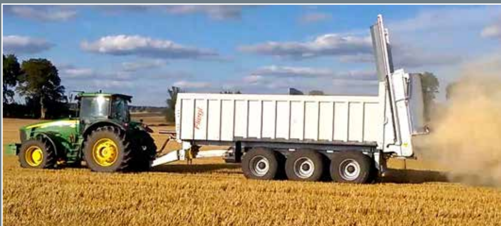
ASW 373 Tiger с защитной решеткой для защиты от попадания посторонних предметов
