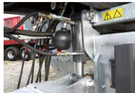
Гидравлически поддресоренное дышло, начиная от модели ASW 256 – бесступенчатая регулировка высоты прицепа
