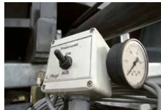
Клапан давления, посредством которого регулируется ограничение давления при уплотнении груза, например силоса
