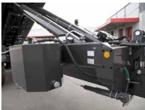
Бортовая гидравлика с баком 60 литров (опция 90 литров) приводимая в движение через карданный вал с гидравлической помпой и ёмкостью для масла
