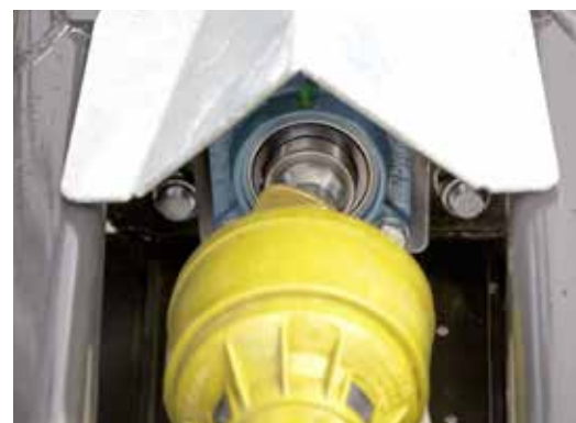
Бортовая гидравлика с баком 60 литров (опция 90 литров) приводимая в движение через карданный вал с гидравлической помпой и ёмкостью для масла
