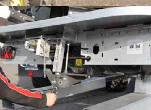
С помощью автоматического регулятора подачи осуществляется автоматическая регулировка скорости выдвигания
