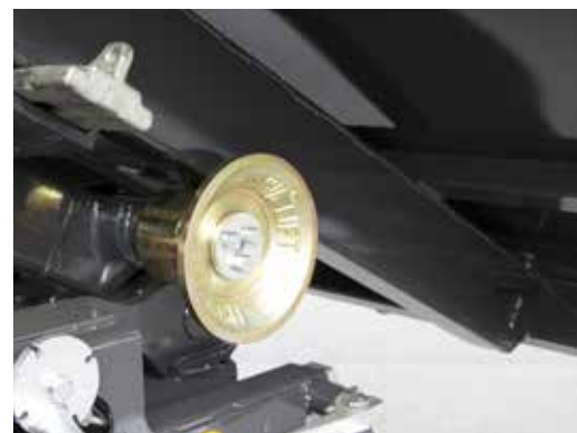
Стальной, литой, скатывающий, центрирующий ролик диаметром 310 мм позволяет особым образом загружать кузов на платформу.
