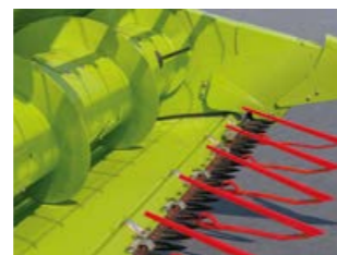
Стол жатки задвинут – уборка зерновых (-100 мм)
