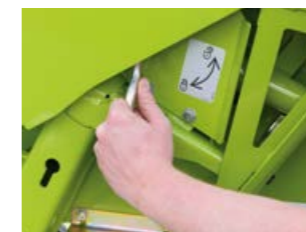
Блокировка стеблелделителей без инструмента с помощью быстродействующего затвора
