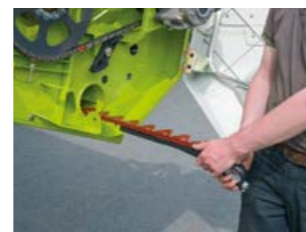
Запасной нож встроен в жатку снизу
