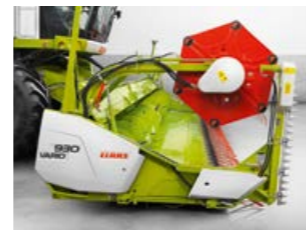
Стол жатки выдвинут – с рапсовым ножом (+600 мм)
