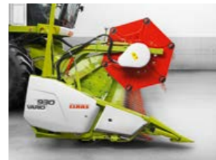
Стол жатки задвинут – уборка зерновых (-100 мм)
