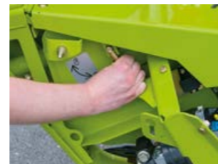
Блокировка стеблелimiters и рапсовых ножей без инструмента с помощью быстродействующего затвора
