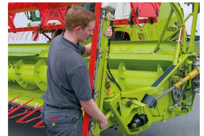
Установка рапсовых ножей с помощью быстродействующего затвора
