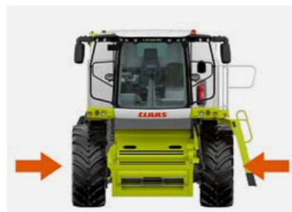
Сниженная транспортная ширина при увеличенной опорной поверхности
