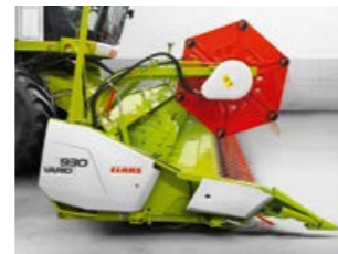
Стол жатки выдвинут – уборка зерновых (+600 мм)
