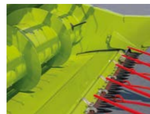
Стол жатки выдвинут – уборка зерновых (+100 мм)
