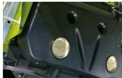
Топливный бак объемом до 750 л.
