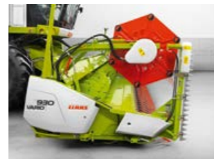
Стол жатки задвинут – с рапсовым ножом (+450 мм)
