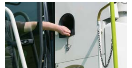
Регулировка выходной секции подбарабья
