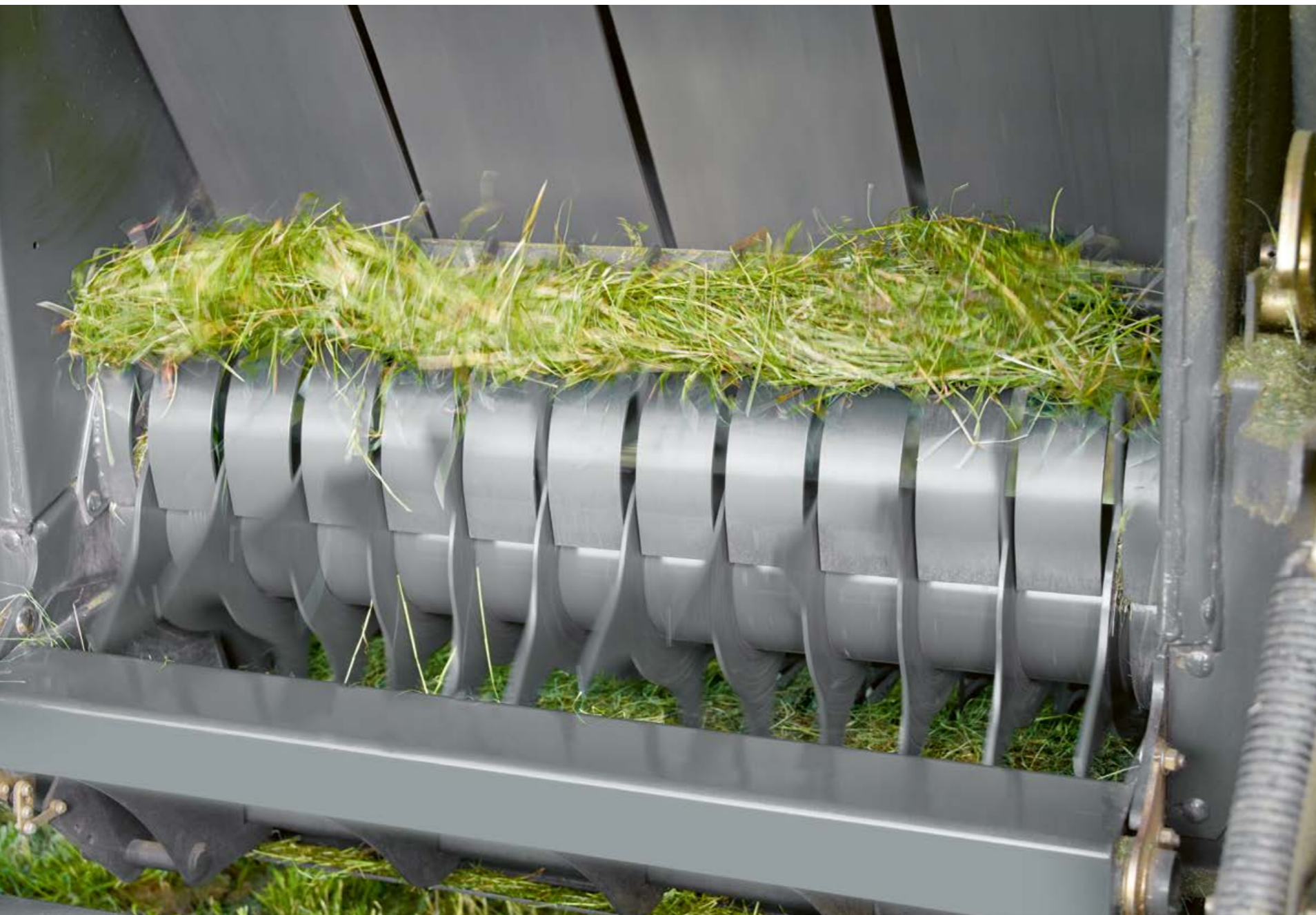
Подающий ротор подает растительную массу в камеру прессования и инициирует начало прессования рулона.
