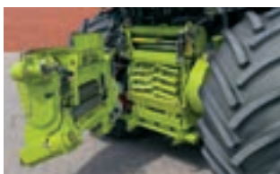
QUICK ACCESS: быстрый доступ к измельчающему барабану V-MAX
