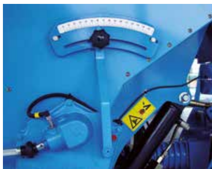
Бесступенчатый редуктор в масляной ванне
